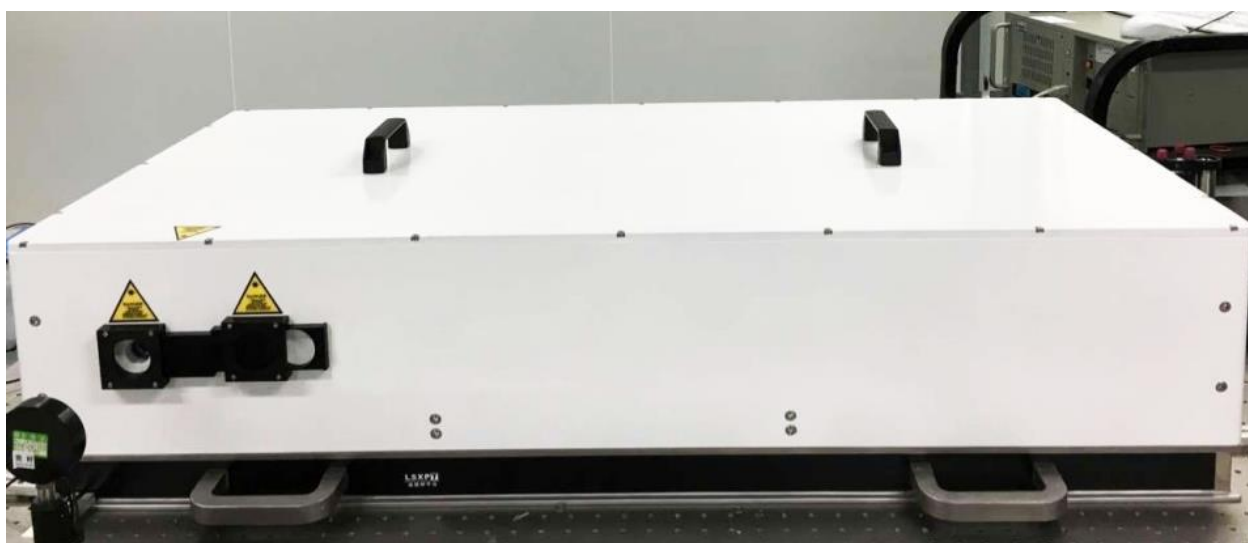
图 2. 激光器实物图 (192-300 nm 连续调谐，尺寸 1300*600*200mm 3 ，不含基频源)
